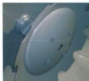
Disques anti-projection avant et arrière : cassent le flux de terre et limitent ainsi leur projection.
