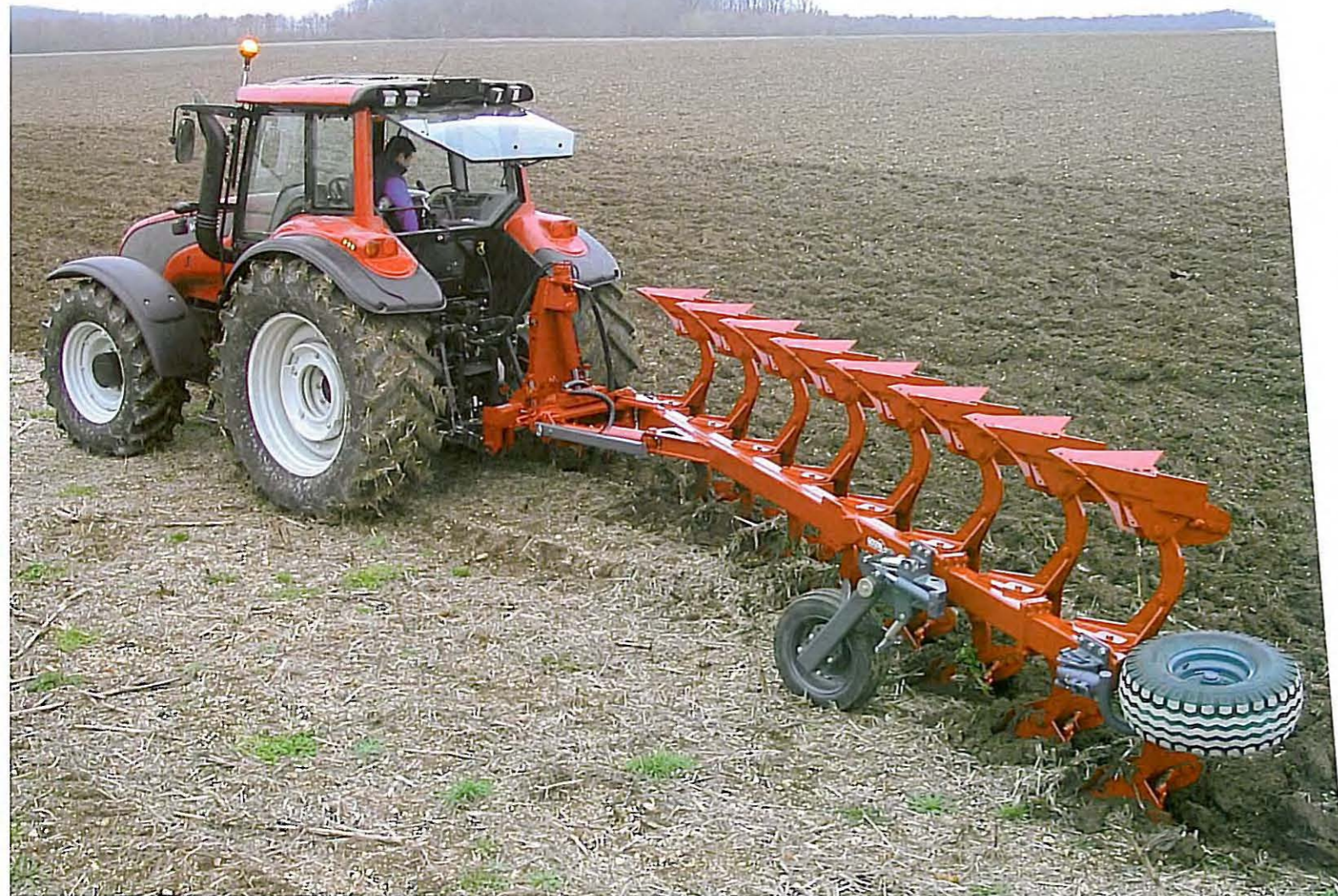
• Charrue à largeur réglable, de 11" à 15", pour labours superficiels ou déchaumage.
