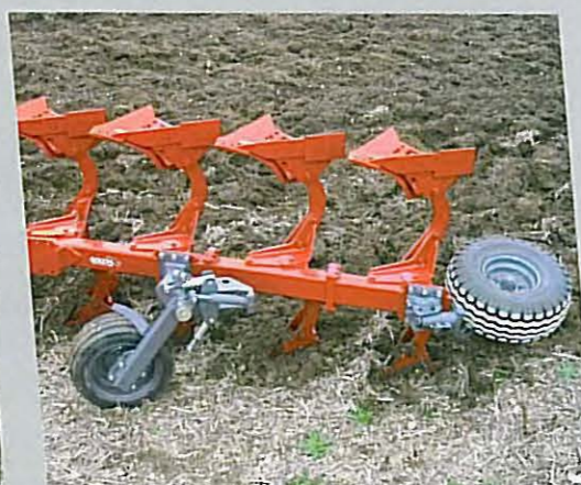
• Finition de parcelle aisée, avec roue en position avancée.
