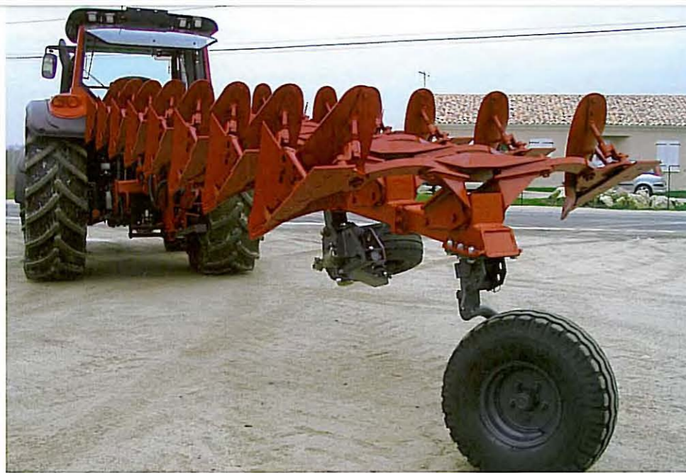
• Charrue PRECILAB 6+1+1 SBC équipée d'une roue de transport horizontal.
