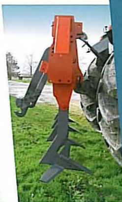
• Attelage arrière à bras flottants, réglables par butées à broches, ou par vérins hydrauliques double effet. Prévu pour un accrochage de l'outil combiné sans démontage.
