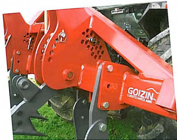
• COMBILAB 600 - Non Stop Hydraulique. Sécurité par Boulon de Cisaillement, largeur 3m, 6 ou 8 lames et 4m, 8 ou 10 lames.
